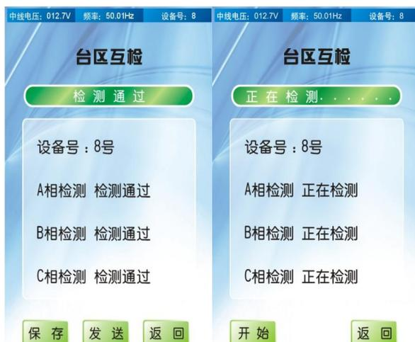
每测试完一相就即时显示当前分机与主机之间的线路连接情况。当三相完全检测通过后，便会提示“检测通过”，表示两台区不存在火线相连情况。
